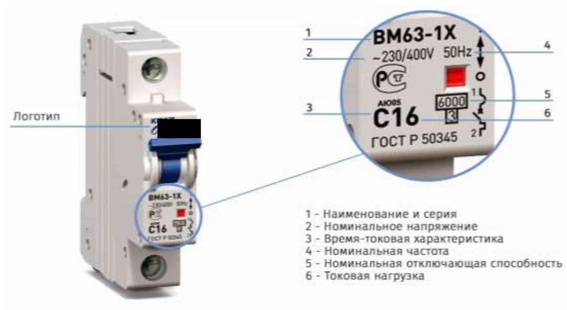
Рисунок 2. Пример маркировки АВ
